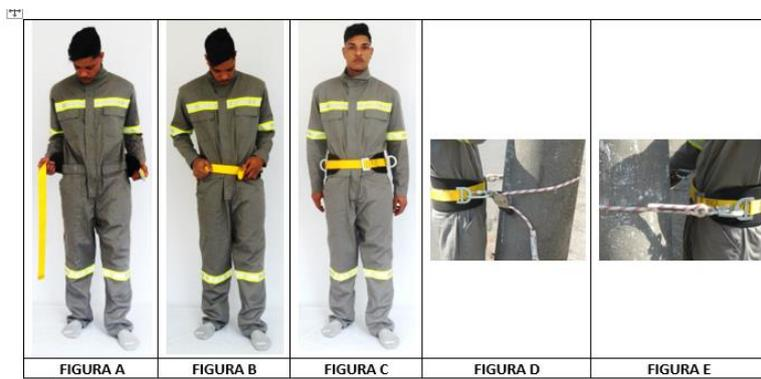
4. **ELEMENTOS DE ACOPLAMENTO:** As argolas tipo “D” nas laterais do cinturão, marcadas com a etiqueta “P”, são para ancoragem, posicionamento ou restrição de movimentação.
