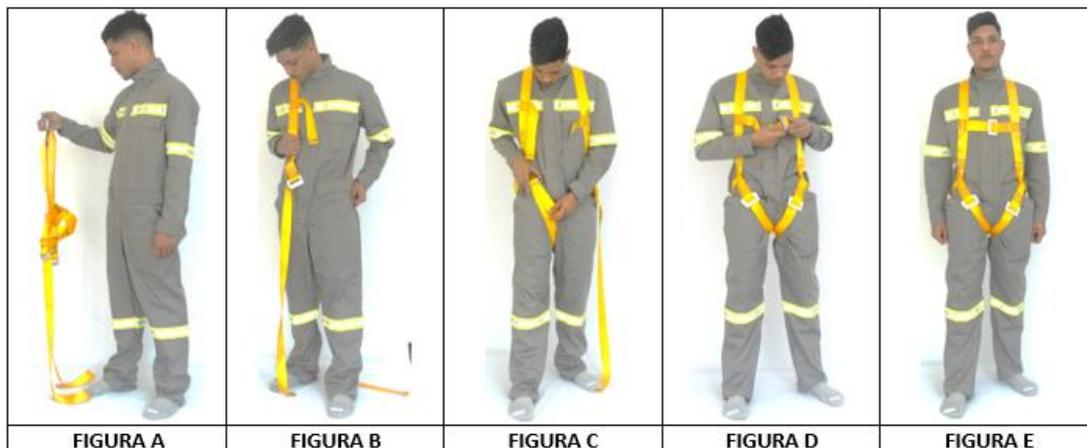
4. **ELEMENTOS DE ACOPLAMENTO:** A argola tipo “D” no dorso do cinturão, marcada com a etiqueta “A”, é para ancoragem e proteção contra quedas e resgate.
